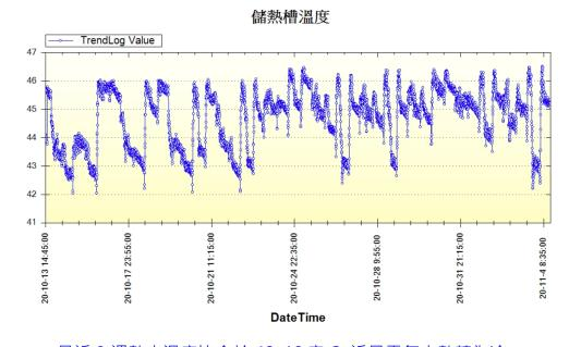
最近 3 週熱水溫度皆介於 42-46 度 C。近日天氣由熱轉為冷, 熱水需求量增加本組也將進行保溫統溫度及熱泵主機加載溫度設 定,以更因應使用者需求。同學倘若還有發生熱水溫度問題,可立 即向舍監反映或給本組將協助查修(電洽:分機 3678 或利用電子維 修表單:編號 1628)。
